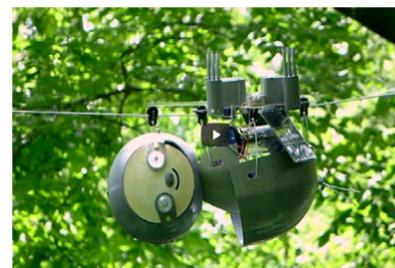
Lento come un vero bradipo, ma si tratta in realtà di un robot. Realizzato dai ricercatori della Georgia Tech, avrà il compito di mimetizzarsi nell'ambiente e tenerlo sotto controllo passando quasi inosservato. Interamente stampato in 3D, il robot bradipo
